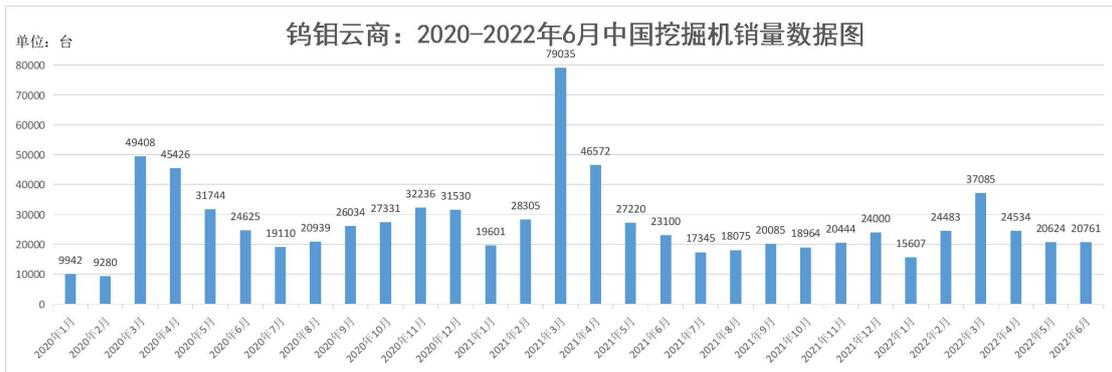
据中国工程机械工业协会对26家挖掘机制造企业统计，2022年6月销售各类挖掘机20761台，同比下降10.1%；其中国内11027台，同比下降35%；出口9734台，同比增长58.4%。
